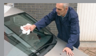
Pulir con toallas de papel hasta que la superficie quede clara y brillante.
