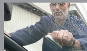
Aplicar la capa de Aquacontrol primero vertical y luego horizontalmente.
